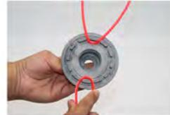
Schneiden Sie sich die Mähfäden auf die passende Länge zu. Empfohlenes Schnittmaß zum Mähen: 30cm - 35cm
