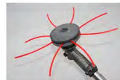
Schrauben Sie den Mähdeckel im Linksgewinde auf das Basisteil
